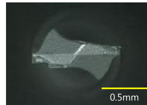
100穴加工後ドリル先端状態
