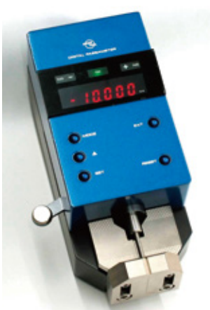
デジタル測定器。 PCBドリルを検査する必要性から誕生した製品。ユニオンツールのドリルの許容公差はわずか数ミクロンであり、その高品質を実現するために自社開発し、製品化もされている。
